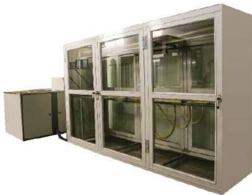
شکل ۱-۶: کابین آزمون چرخه دمایی و مولد مربوطه
