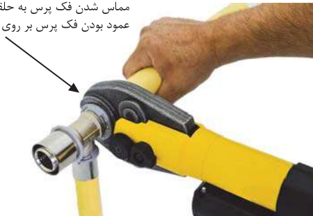
شکل ۴-۲۶: نحوه صحیح اجرای پرس
