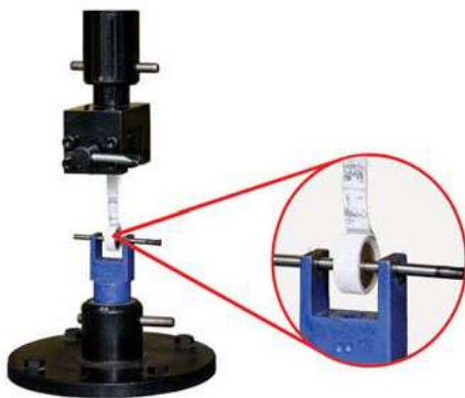
شکل ۴-۶: دستگاه کشش آزمون چسبندگی
