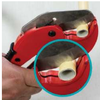
شکل ۴-۲۲: دو پهن شدن لوله در اثر برش ناصحیح
