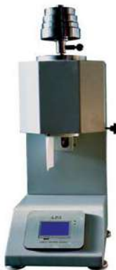
شکل ۶-۵: دستگاه آزمون نرخ جریان جرمی مذاب
