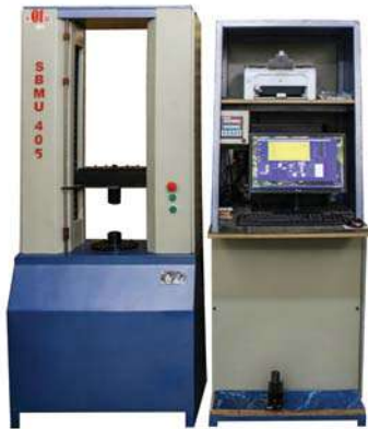
شکل ۸-۶: دستگاه کشش آزمون خواص کششی و کنترل مربوطه
